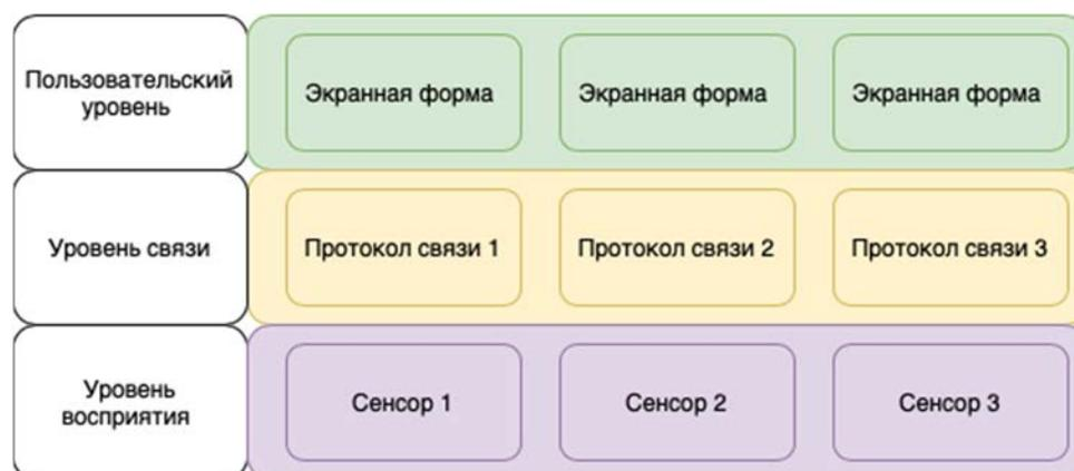
Рис. 1. Архитектура ASIS программной среды микроконтроллера
