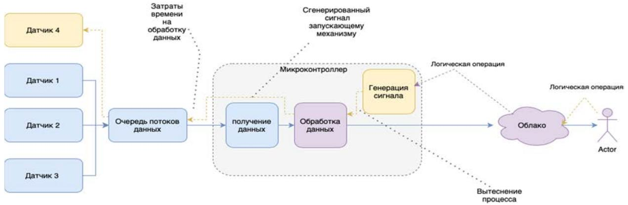
Рис. 2. Упрощенная схема AS-IS принципа работы «интеллектуального» микроконтроллера
